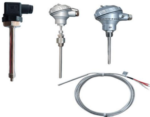
Os termômetros de resistência são sensores de temperatura que operam baseados no princípio da variação da resistência ôhmica em função da temperatura. Seu elemento sensor na maioria das vezes é feito de platina com o mais alto grau de pureza e encapsulado em bulbos de cerâmica. Usado principalmente em indústria alimentícia, farmacêutica, laticínios, laboratoriais entre outros.
