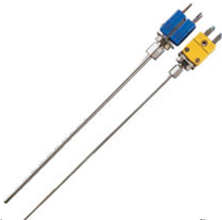
Permite uma rápida e fácil conexão com os fios ou cabos de extensão. O conector é polarizado, o pino negativo possui um diâmetro maior, evitando a inversão na ligação. Disponível em dois tamanhos, standard e mini.
