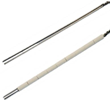
Os termopares desta série requerem uma proteção adicional e são normalmente elementos de reposição utilizados nas montagens com tubo de proteção e cabeçote, sendo também compatíveis para uso em conjuntos de outros fabricantes. Os fios dos termopares com bitolas menores proporcionam tempo de resposta mais rápido e menor vida útil e bitolas maiores proporcionam maior vida útil, porém, tempo de resposta maior.
